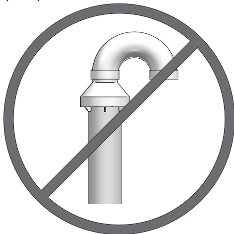
Figure 5-5 Ne pas ajouter un raccord en « U » au chapeau pare-pluie
